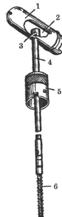
Мал. 37. Приладдя автомата, підготовлене для чищення: 1 - пенал; 2 - викрутка; 3 - головка шомпола; 4 - шомпол; 5 - кришка пенала; 6 - протирка
