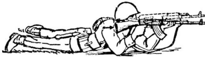
Мал. 46. Підкидання дулової частини ствола зброї догори під час пострілу внаслідок віддачі
